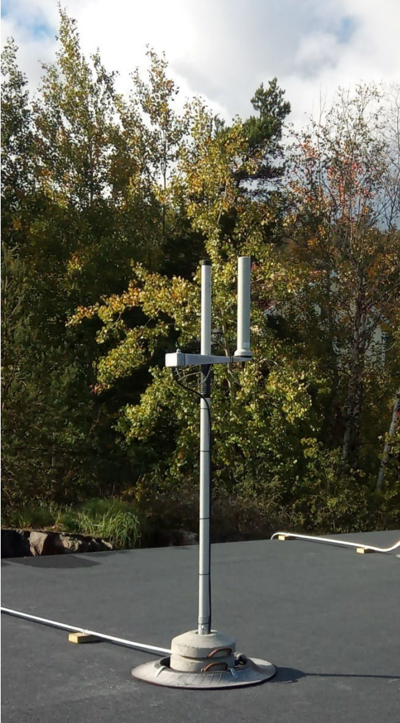
Kuva 3.2. Ulkoisen säteilyn valvontaverkon mittausasema Dragsfjärdissä.
