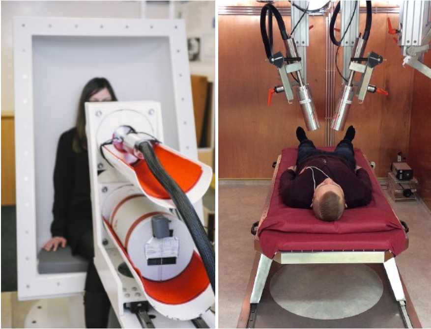
Kuva 10.1b. Liikkuvan laboratorion taustasuojia ja ilmaisimet ja STUKin toimitiloissa oleva gammamittauslaitteisto. Bild 10.1b. Mättningsstol i det mobila laboratoriet och gammamätning i STUK. Fig. 10.1b. The background shield and detectors of the mobile unit and gamma measurement at STUK.
