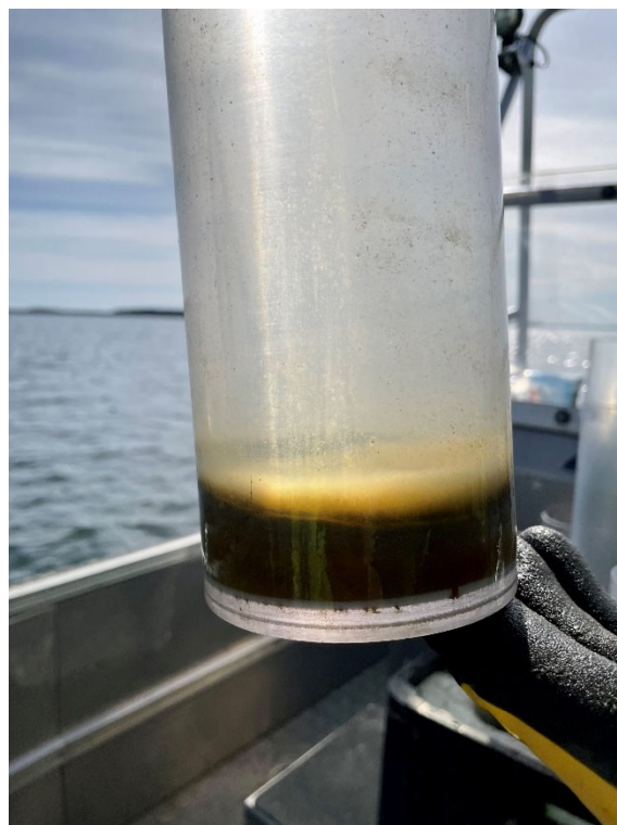
Bild 13. Insamlare av sedimenterbart material och insamlingsrör i slutet av provtagningsperioden.
