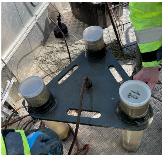
Bild 13. Insamlare av sedimenterbart material och insamlingsrör i slutet av provtagningsperioden.
