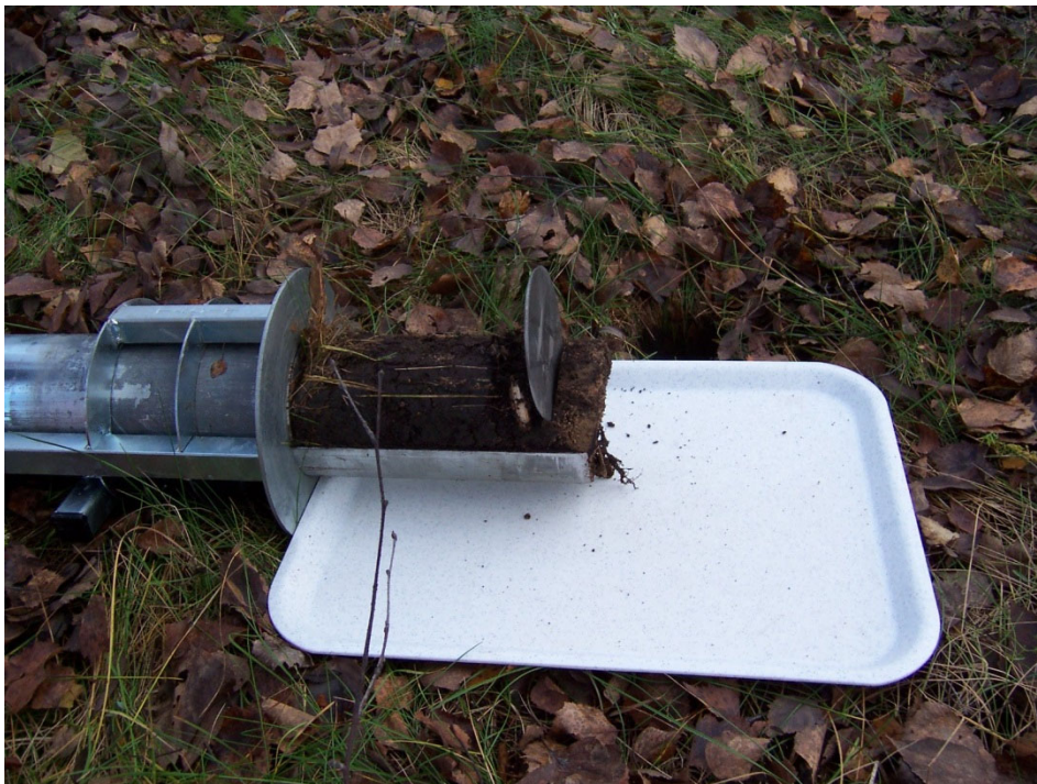
Bild 6. Skärning av jordmånsprov som tagits med en golfhålsborr.
