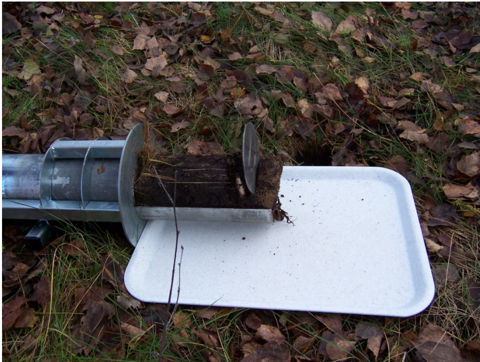
Kuva 6. Golfreikäkairalla otetun maaperänäytteen viipalointi.
