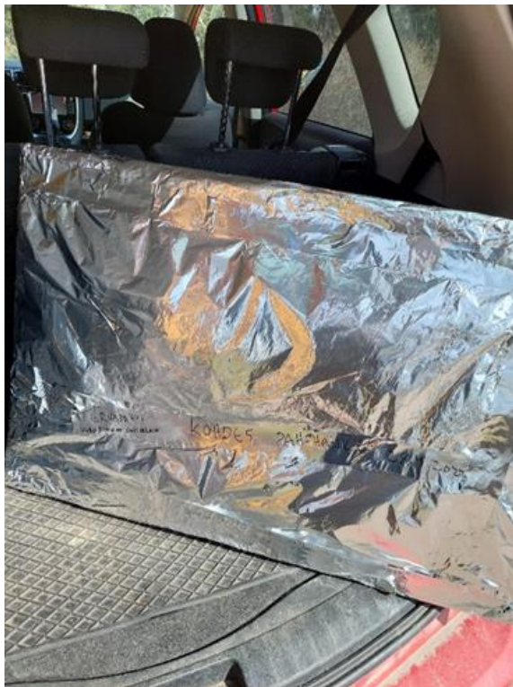
Kuva 39. Tervapahvi suojattiin alumiinifoliolla ja reunat teipattiin tiiviisti alumiiniteipillä.
