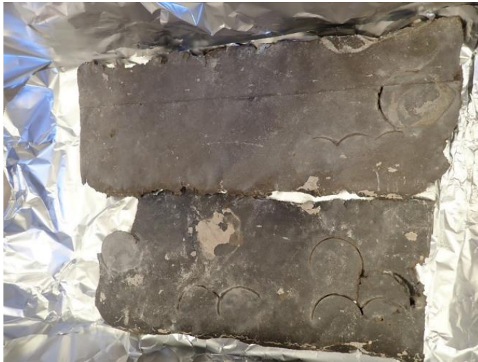
Kuva 23. Ulkoseinän harkkoeristeiden pinnalta irrotettuja tervapapereita pakattuna alumiinifolioon.
