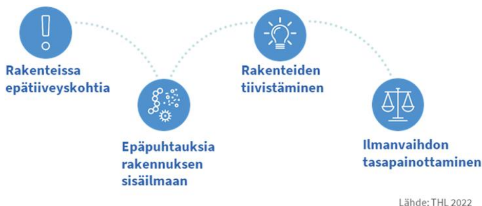
Kuvio 3. Rakenteiden tiivistämisellä estetään epäpuhtauksien pääsyä sisäilmaan.
