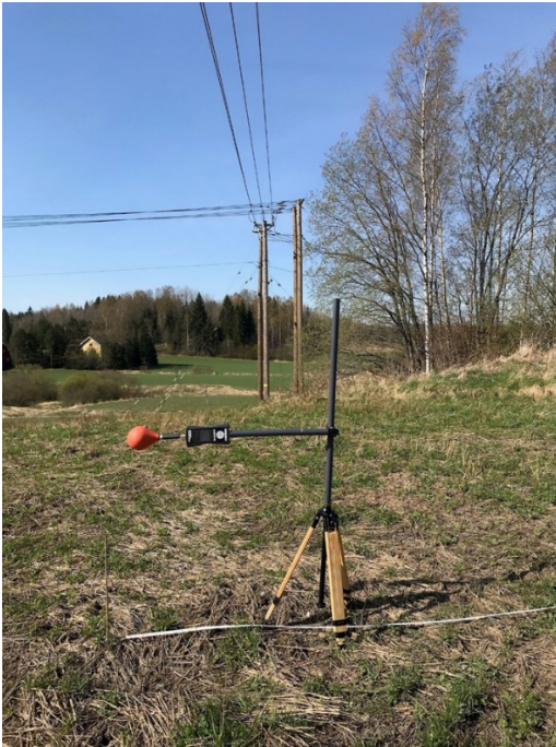
Kuva 11. Sähkökentän voimakkuuden mittaus taso-orteen asennetun PAS-johdon alla.
