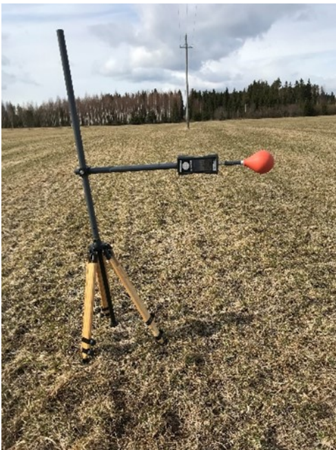
Kuva 5. Sähkökentän voimakkuuden mittaus kolmio-orteen asennetun 20 kV:n ilmajohdon alla.
