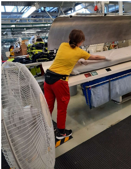
Kuva c_4. Työskentelyä verhoprässäämöllä. Prässin lämpötila on noin 170 °C.
