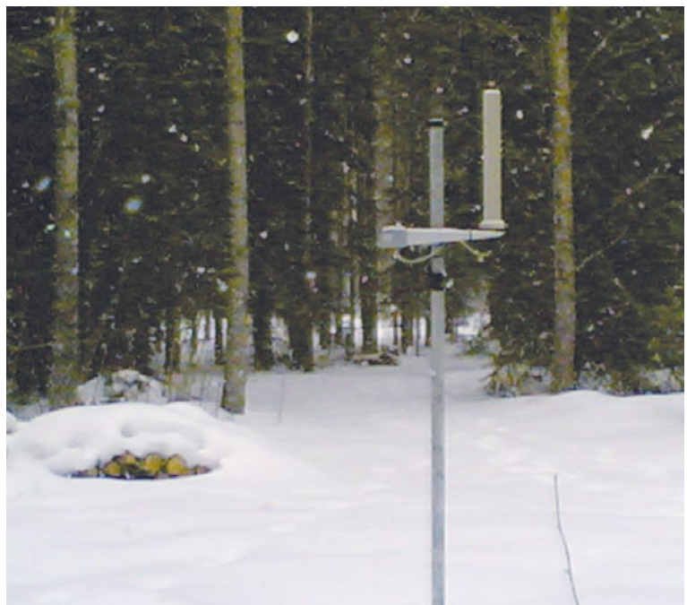
Kuva 2.2. Ulkoisen säteilyn valvonta-aseman mitausanturi (11855 Orimattila). Bild 2.2. Detektor vid en mätstation för extern strålning (11855 Orimattila). Fig. 2.2. Detector of an automatic dose rate monitoring station (11855 Orimattila).
