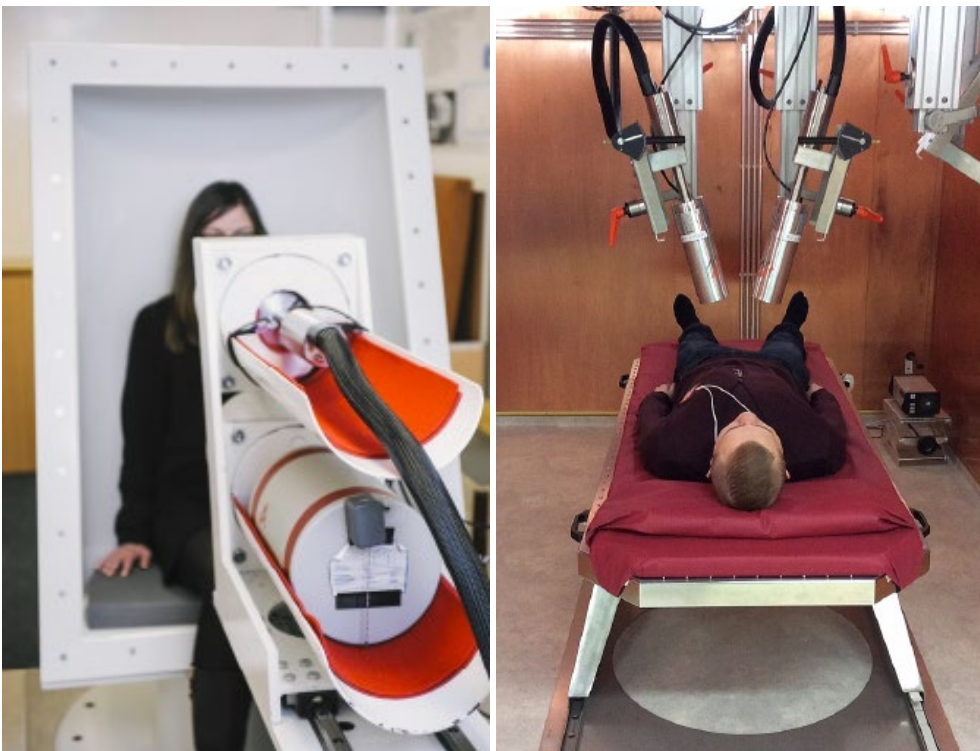
Kuva 10.1b. Liikkuvan laboratorion taustasuojia ja ilmaisimet ja STUKin toimitiloissa oleva gammamittauslaitteisto. Bild 10.1b. Mätningstol i det mobila laboratoriet och gammamätning i STUK. Fig. 10.1b. The background shield and detectors of the mobile unit and gamma measurement at STUK.
