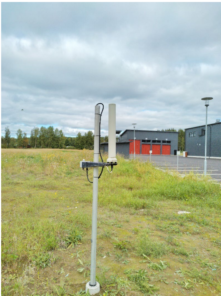
Kuva 3.2. Ulkoisen säteilyn valvontaverkon mittausasema Nurmeksessa. Bild 3.2. Detektorer vid mätstationen Nurmes i övervakningsnätet för extern strålning. Fig. 3.2. Detectors of the automatic dose-rate monitoring station at Nurmes.
