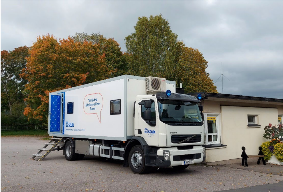
Kuva 10.1a. Kokokehomittauksissa käytettävä liikkuva laboratorio. Bild 10.1a. Det mobila laboratoriet som används för helkroppsmätningar. Fig 10.1a. The mobile laboratory used in the whole-body measurements.
