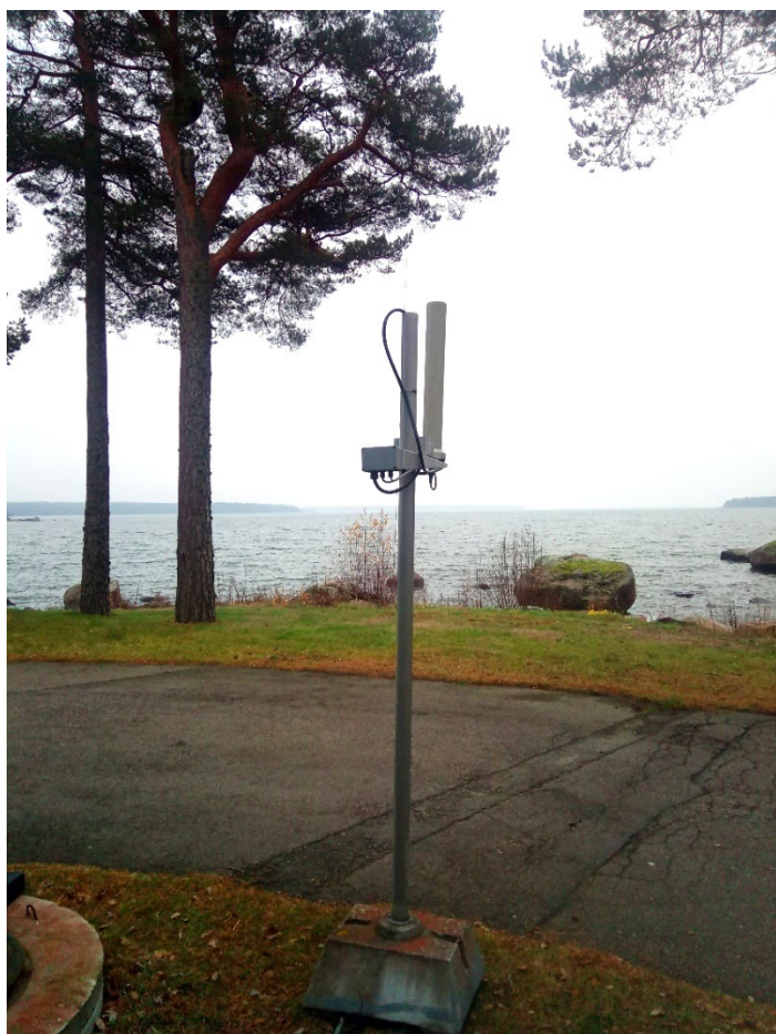
Kuva 3.2. Ulkoisen säteilyn valvontaverkon mittausasema Hurppu Virolahdessa.
