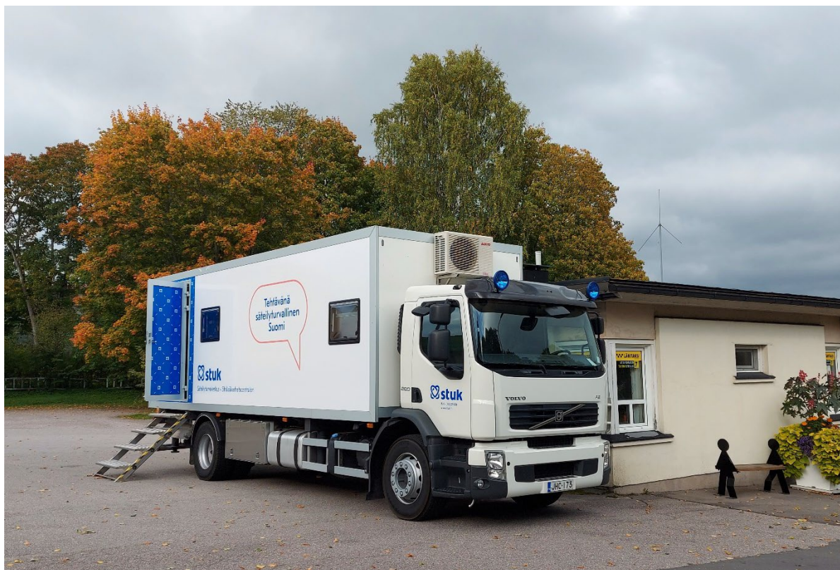
Kuva 10.1a. Kokokehomittauksissa käytettävä liikkuva laboratorio.
