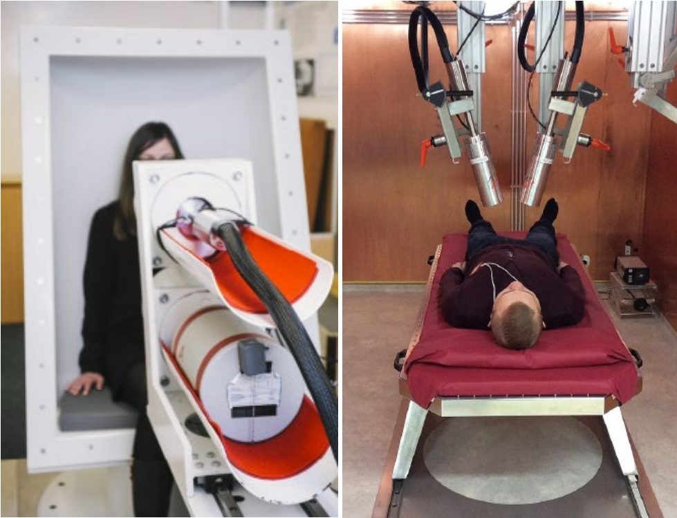
Kuva 10.1b. Liikkuvan laboratorion taustasuoja ja ilmaisimet ja STUKin toimitiloissa oleva gammamittauslaitteisto.
