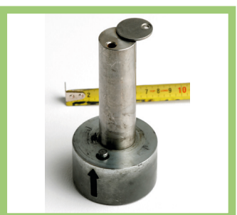
Pistemäisen säteilylähteen pidike
