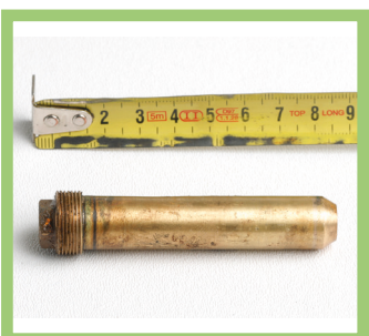
Pistemäisen säteilylähteen pidike
