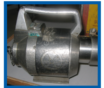
Vanhan radiografialaitteen suojus
