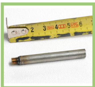
Pistemäisen säteilylähteen pidike
