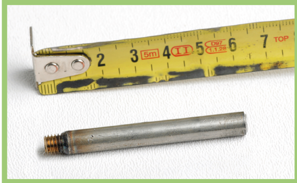
Pistemäisen säteilylähteen pidike
