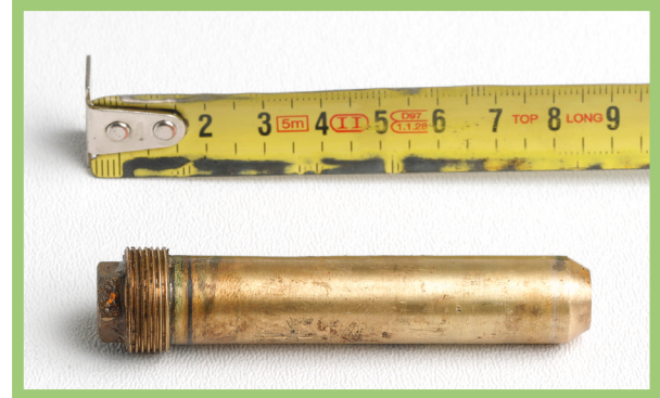
Pistemäisen säteilylähteen pidike
