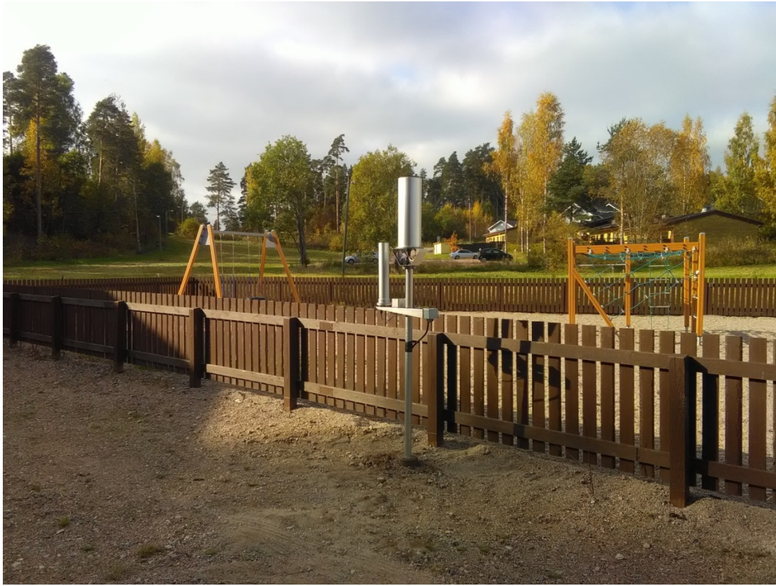
Kuva 3.2. Ulkoisen säteilyn valvontaverkon mittausaseman Pernajan anturit. Bild 3.2. Detektorer vid mätstationen Pernå i övervakningsnätet för extern strålning. Fig. 3.2. Detectors of the automatic dose-rate monitoring station at Pernaja.
