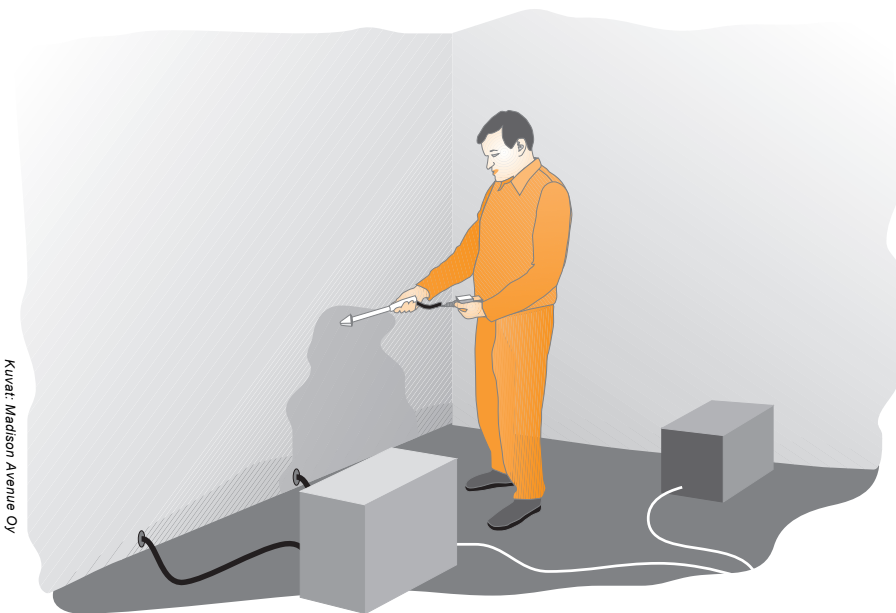
Mikroaaltosäteilyn mittaaminen kuivattavan kohteen läheisyydessä.
