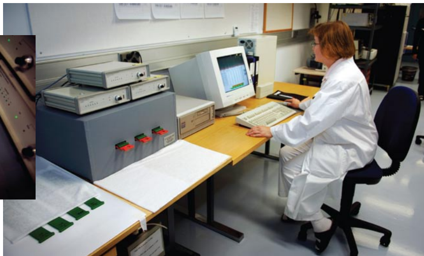
Laskeumanäytteiden strontium-90-määritys verrannollisuuslaskurilla. Laitteella voidaan mitata samanaikaisesti 15 näytettä.
