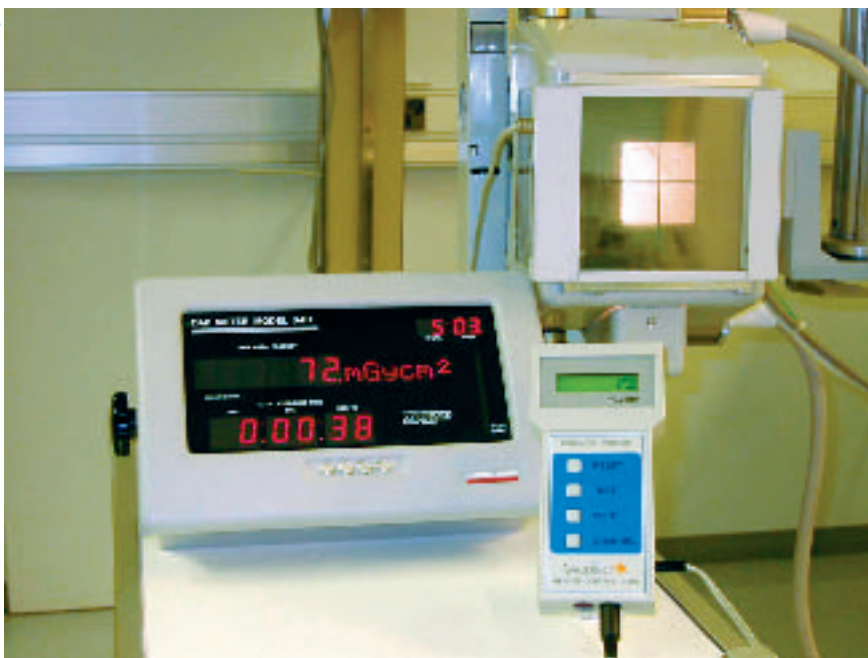
DAP -mittari: röntgenputken kaihdinkoteloon kiinnitetty litteä ionisaatiokammio (yllä oikealla). Kammioon on kytketty kaksi näyttöosaa (edessä).
