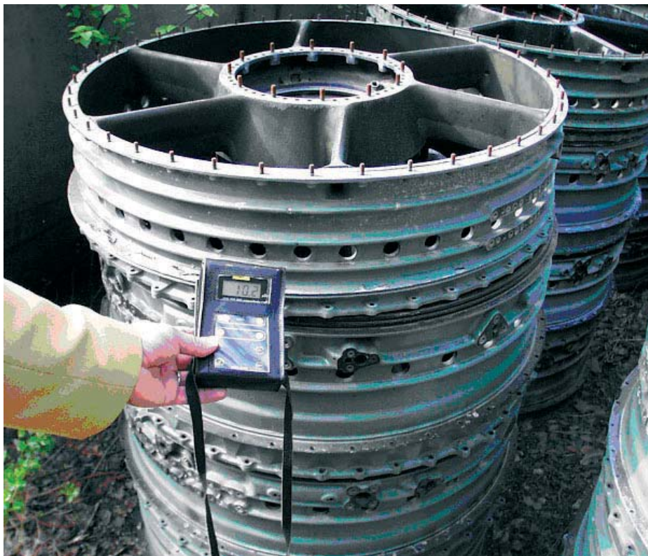
Kuva 3. Draken-hävittäjien moottorinosat sisältävät kolmisen prosenttia toriumia, minkä vuoksi annosnopeus lähituntumassa on noin kymmenen mikrosievertiä tunnissa. Osat luokitellaan ydinmateriaaliksi niiden toriumpitoisuuden vuoksi.
