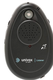
Kuva 24 Induktiosilmukan kentän testaukseen tarkoitettu laite eli kenttävoimakkuusmittari. Kuva GN ReSound Finland Oy/Ab.
